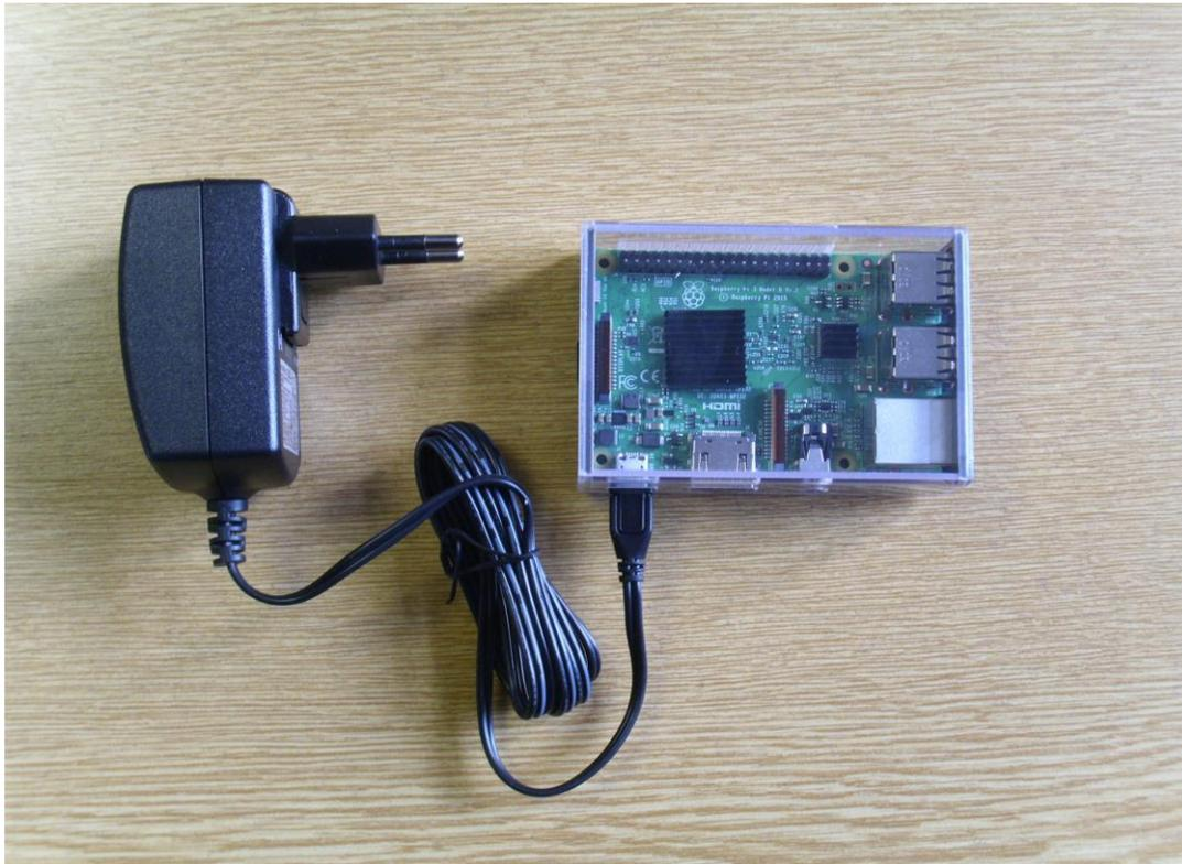
Verbinden Sie den LINKSYS Gigabit USB 3.0 Ethernet Adapter (Schutzabdeckungen entfernen) und den NAVILOCK GPS Empfänger mit den Raspberry USB Anschlüssen.
